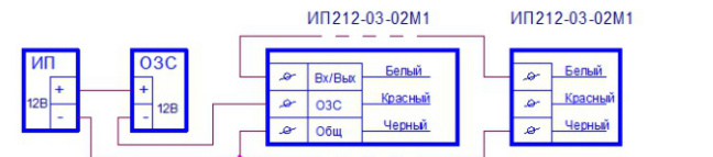
Подключение внешнего ОЗС к ИП212-03-02М1 (ИП – источник питания для ОЗС).
